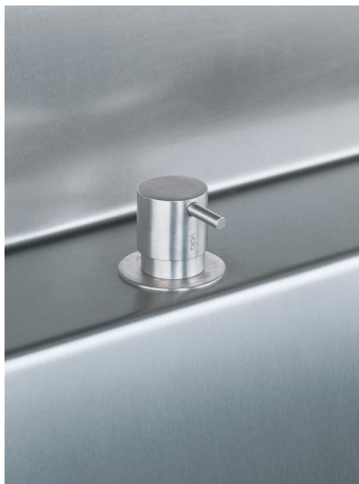
S50 Stopp ventil med keramisk tätning, S50, för sargmontage, 60 mm täckbricka 001G. Med backventil. 1/2" anslutning. Håltagning: 30 mm.
